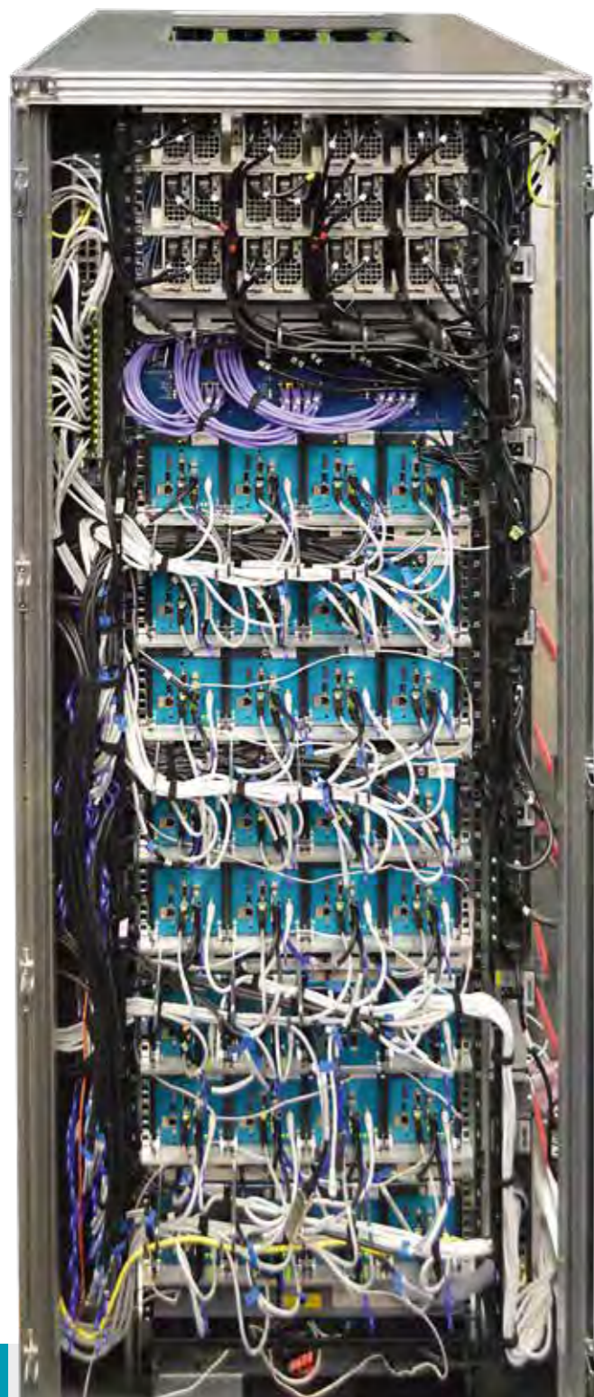
3 QPACE-2-Supercomputer für Simulationen der Quantenchromodynamik, entwickelt in der Theoretischen Teilchenphysik.
