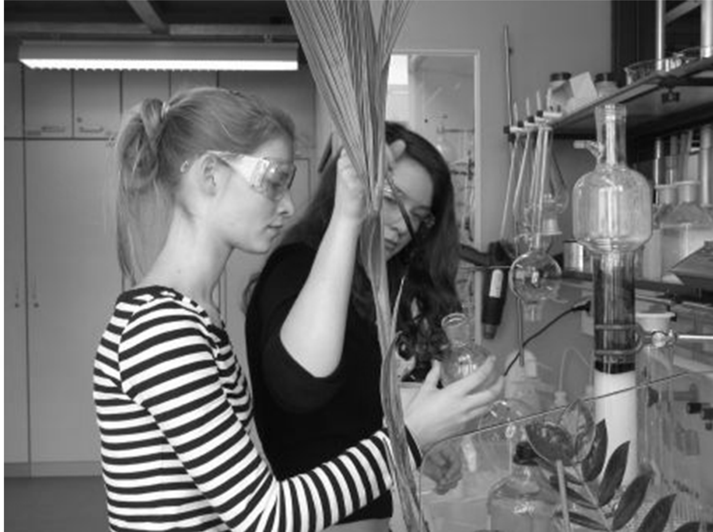
Abb. 3: Durchführen einer Säulenchromatographie
