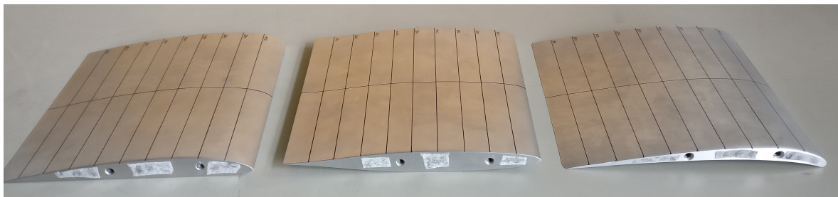
Abbildung wk.6: Die im Versuch verwendeten Tragflächenprofile (klassisch, symmetrisch, laminar)
