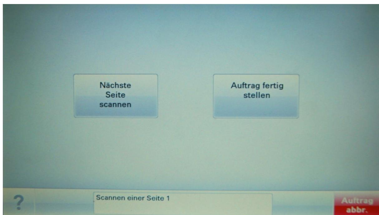
Falls mehrere Seiten zu kopieren sind, erfolgt dies durch das seitenweise Scannen über die Funktion **Nächste Seite scannen**. Erst mit der Funktion **Auftrag fertig stellen** werden alle kopierten Seiten ausgegeben.
