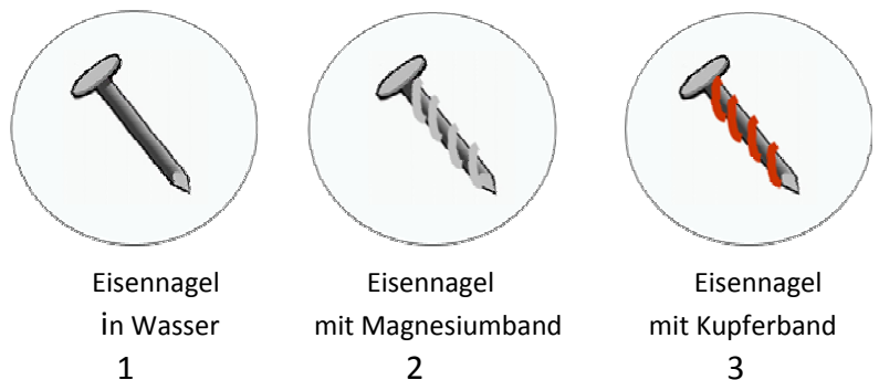
Abb. 3 Rostschutz durch Opferanode [5]
