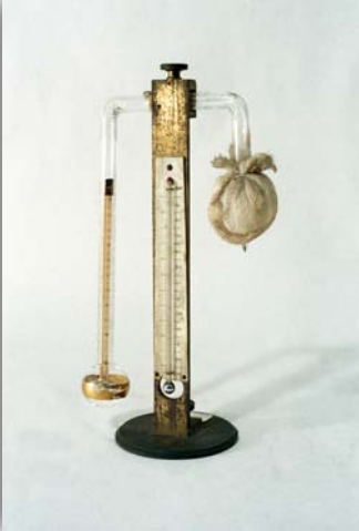
Hygrometer nach John Frederick Daniell, 1865/66. Aus dem Taupunkt ließ sich der Feuchtigkeitsgehalt der Luft berechnen.
