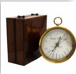
Aneroïd-Barometer nach Lucien Vidie, 1857. Die Ausdehnung einer Metalldose zeigt den Luftdruck an.
