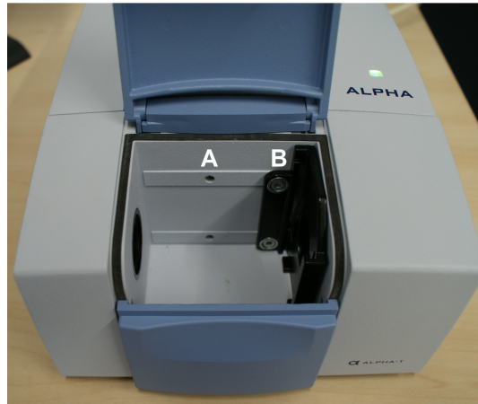
Abbildung 1: Für Transmissionsmessungen muss sich die Haltevorrichtung auf Position A befinden.
