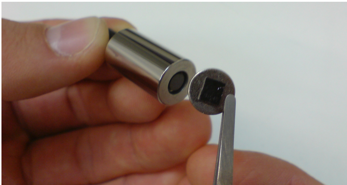
Abbildung 4.2: Vorsichtig die Probe mit der Pinzette auf den magnetischen Probenhalter legen!
