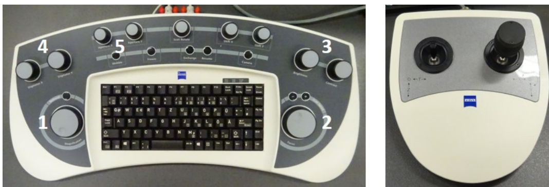
Abbildung 7: Links: Steuerkonsole für das REM. 1) Einstellung der Vergrößerung bzw. Auswahl, ob gesamter Abbildungsbereich oder nur ein Ausschnitt davon dargestellt werden soll. 2) Einstellung des Fokus. 3) Einstellung von Helligkeit und Kontrast. 4) Astigmatismus-Korrektur 5) Justage der Aperturblende. Rechts: Steuerkonsole für den Probenstisch. Mit dem linken Joystick wird die Höhe und Kippung des Tisches justiert, mit dem rechten Joystick die x- und y-Position sowie die Drehung des Proben Tellers.
